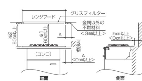
※左記離隔距離とれない場合は、必ず防熱板による防火措置を行ってください。防熱板を取り付けなかった場合、火災のおそれがあります。
