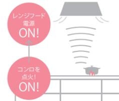
コンロの点火と同時にレンジフードが自動で換気を始めます。コンロを消火すると自動で停止します。
