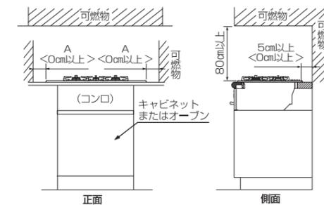
※< >内は、周囲の壁が不燃材で有効に仕上げた部分もしくは、防熱板を取り付けたときの寸法です。
